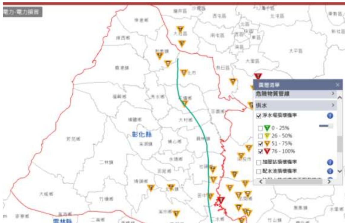
圖 1-3-9 模擬淨水廠損壞機率
